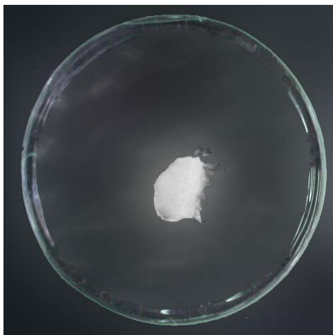
Figura 3 – Látex não vulcanizado, após ter sido exposto ao tolueno
